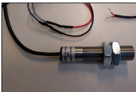
7. ábra: Optikai LED szenzor (ROS-P Monarch Instrument)
